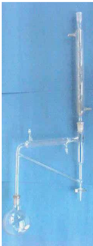
Figura 1 - Fotografia do aparelho Clevenger utilizado para extração do óleo essencial das folhas de capim-limão.
